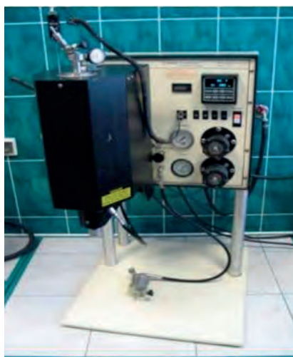
Fot. 2. Prasa filtracyjna
