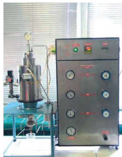
Fot. 3. Urządzenie do badania migracji gazu
