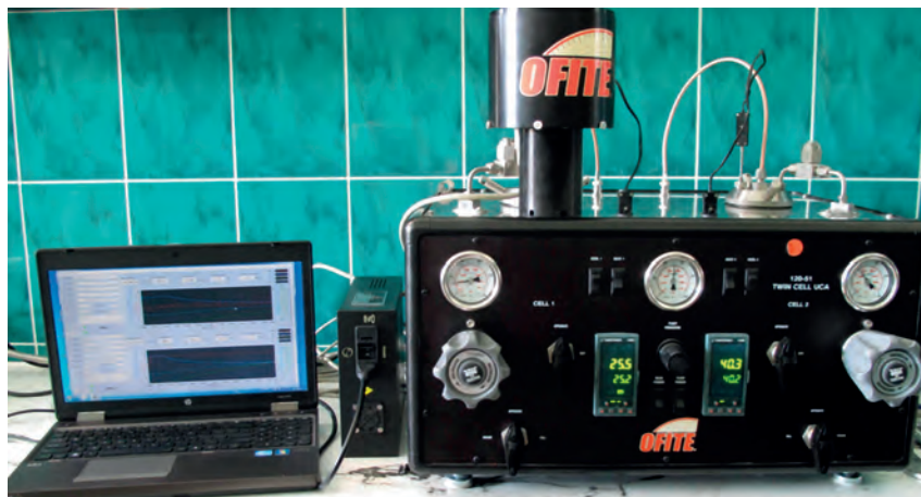
Fot. 4. Ultradźwiękowy analizator wytrzymałości mechanicznej stwardniałego zaczynu oraz analizator narastania statycznej wytrzymałości strukturalnej płynnego zaczynu
