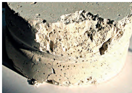
Fot. 7. Odłam z próbki płaszcza cementowego (widoczne pustki)
