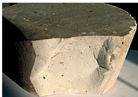
Fot. 10. Odłam z próbki płaszcza cementowego (jednolita struktura)
