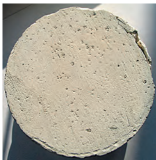
Fot. 6. Przekrój płaszcza cementowego (nieciągłości stwardniałego zaczynu)
