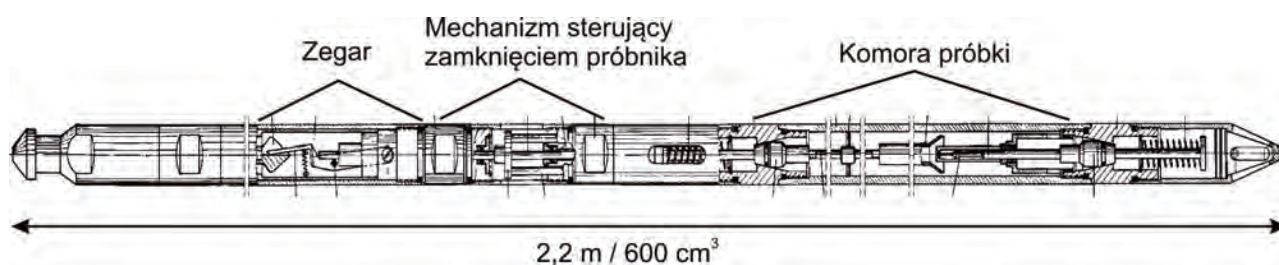
Rys. 3. Schemat próbnika węglanego z otwartym przepływem – typu PNL [3]
