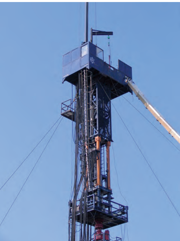
Otwór Bogdaj Uciechów 102H – operacje przy użyciu urządzenia snubbing. Fot. arch. PN „Diamant” Sp. z o.o.
