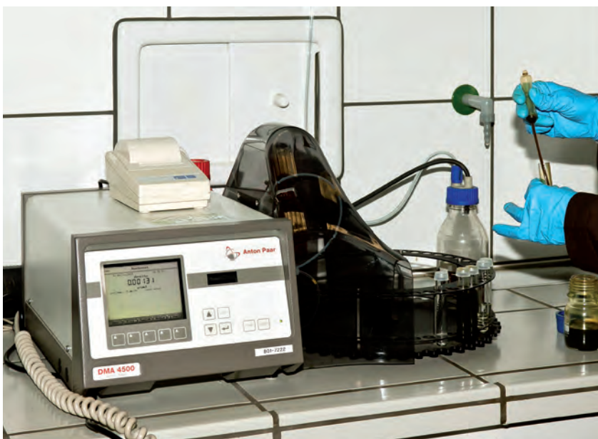
Gęstościomierz może oznaczać gęstości w zakresie temperatur 0-90^\circ\text{C} , w laboratorium badania prowadzone są w standardowych warunkach odniesienia, które wynoszą 15^\circ\text{C} . Fot. Włodzimierz Barański
