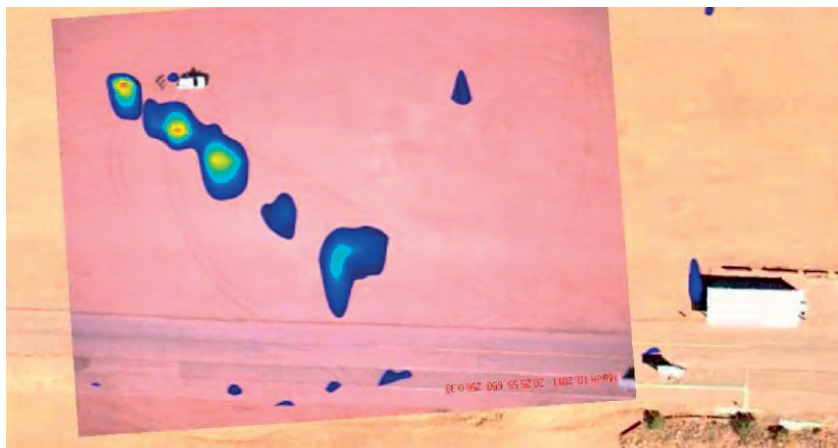
Chmura wyciekającego metanu zmierzona techniką realSens bazującą na GFCR (Copyright Synodon Inc.)
