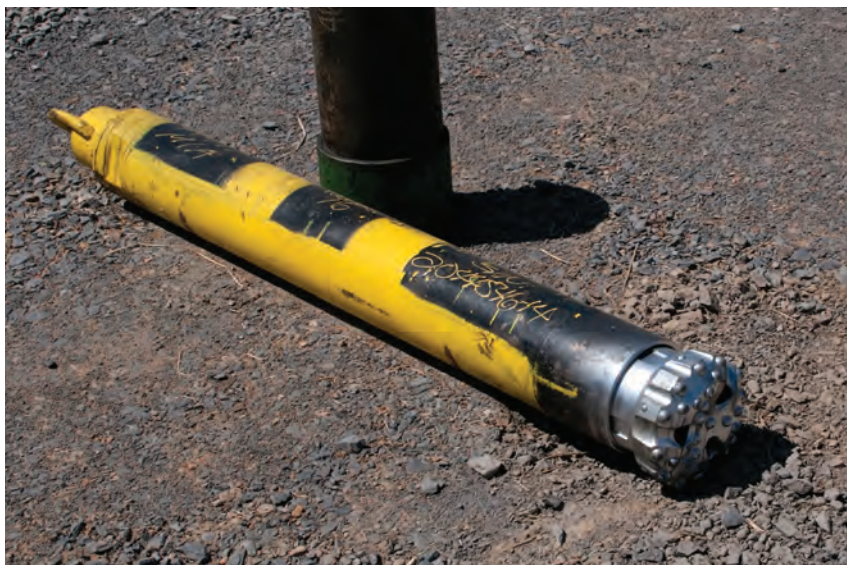
Dział naftowy firmy Luby's Equipment Services w Heber Springs, Arkansas, utrzymuje należące do Southwestern Energy koronki, młotki i narzędzia w doskonałym stanie. Młotek Atlas Copco TD 85 z koronką 8,875 cala wkrótce wykona pionową część otworu w zbitych i twardych wapieniach do głębokości, gdzie rozpocznie się budowanie kąta otworu horyzontalnego, powyżej złoża łupków. Przed powrotem do Little Rock polska delegacja odwiedziła firmę Luby's, gdzie obserwowała techników kontrolujących elementy młotów i przywracających im pełną sprawność oraz szykujących je do szybkiego powrotu do pracy w Southwestern Energy. Fot. arch. Atlas Copco Polska Sp. z o.o.
