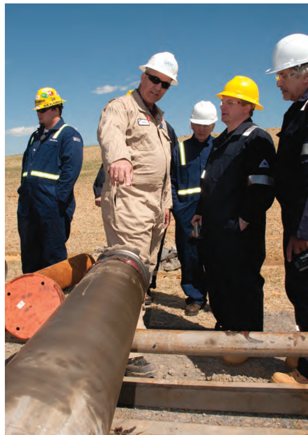
Deck Travis, nadzorujący obszar odwiertów Southwestern Energy, pokazuje inżynierom z PNiG Kraków jeden z młotków Atlas Copco QL 120 z koronką 12,45 cala używanym do wierzenia pierwszych 1000 stóp pionowego odcinka odwiertu. Po odwierceniu odcinka pionowego przy użyciu technologii młotkowej, otwory zostają zatłoczone płuczką bentonitową i oczekują na przybycie konwencjonalnej wiertnicy, która wykona poziomy odcinek do końcowej głębokości 6000 stóp (1828 m) i zarurowaniem kolumną eksploatacyjną 51/2 cala (140 mm). Fot. arch. Atlas Copco Polska Sp. z o.o.
