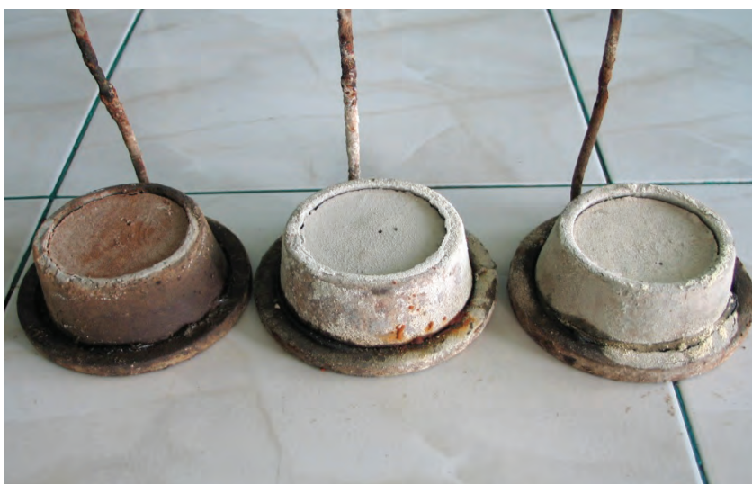
Fot. 1. Mieszanki cementowo – płuczkowe po sezonowaniu w temperaturach 20, 40 i 60°C
