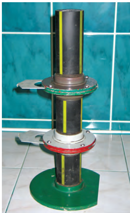
Fot. 3. Aparat do badań sedymentacji mieszaniny uszczelniającej
