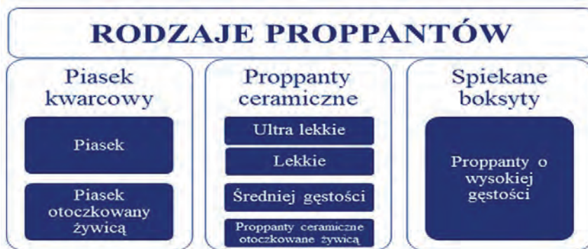
Rys. 6. Podział proppantów ze względu na budowę [źródło: opracowanie własne BALTIC CERAMICS]
