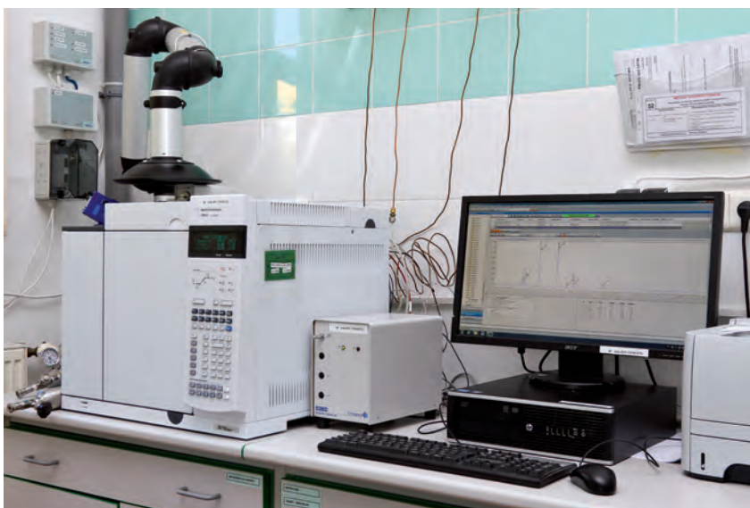
Oznaczanie związków siarki w gazie ziemnym odbywa się przy użyciu chromatografu gazowego firmy Agilent Technologies 7890A. Fot. Włodzimierz Barański
