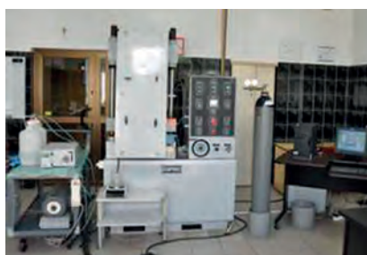
Fig. 7. Stanowisko Proppant Conductivity do badań materiałów podsadzkowych (źródło: materiały własne zakładu)
