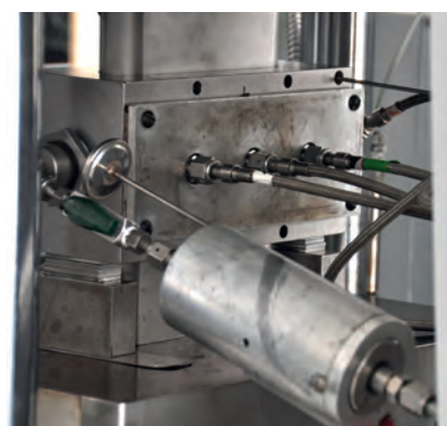
Fig. 6. Komora pomiarowa stanowiska badawczego Proppant Conductivity (źródło: materiały własne zakładu)
