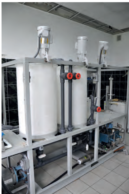
Fig. 8. System przygotowania i tłoczenia płynów zabiegowych w skali półtechnicznej (źródło: materiały własne zakładu)
