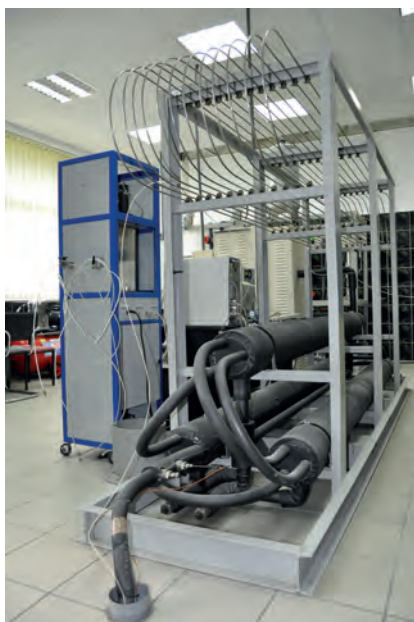
Fig. 8. System przygotowania i tłoczenia płynów zabiegowych w skali półtechnicznej (źródło: materiały własne zakładu)
